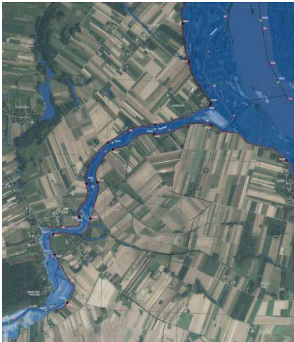
Rysunek 36 Mapa zagrożenia powodziowego wraz z głębokością wody obszaru na których prawdopodobieństwo wystąpienia powodzi jest wysokie i wynosi raz na 10 lat – Wola Pawłowska
